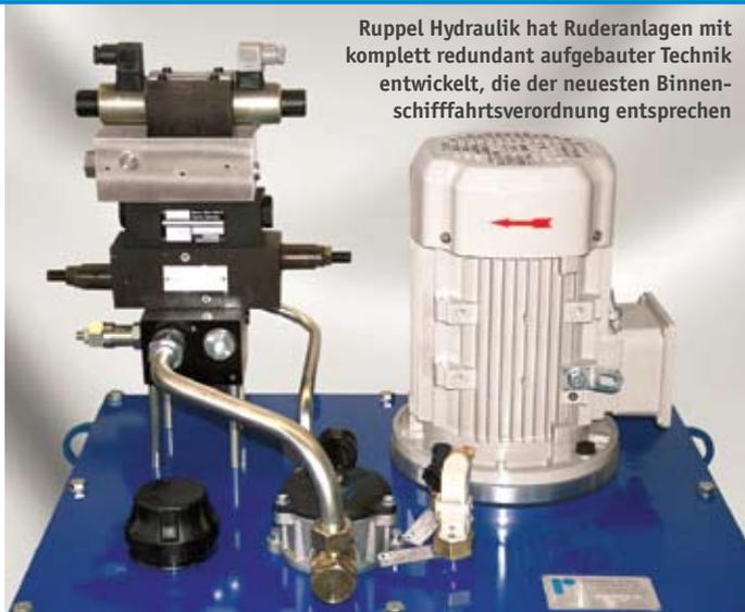
Ruppel Hydraulik hat Ruderanlagen mit komplett redundant aufgebauter Technik entwickelt, die der neuesten Binnenschiffahrtsverordnung entsprechen
