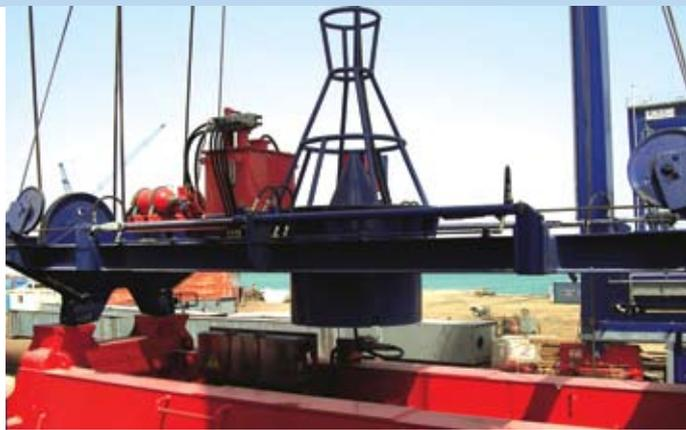
Für den Ship-to-shore-Umschlag hat Ruppel Hydraulik hydraulische Lastpendeldämpfungen entwickelt....
