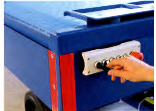
3: Über das Bedientableau an der Stirnseite des Wagens steuert der Bediener alle Bewegungsabläufe
