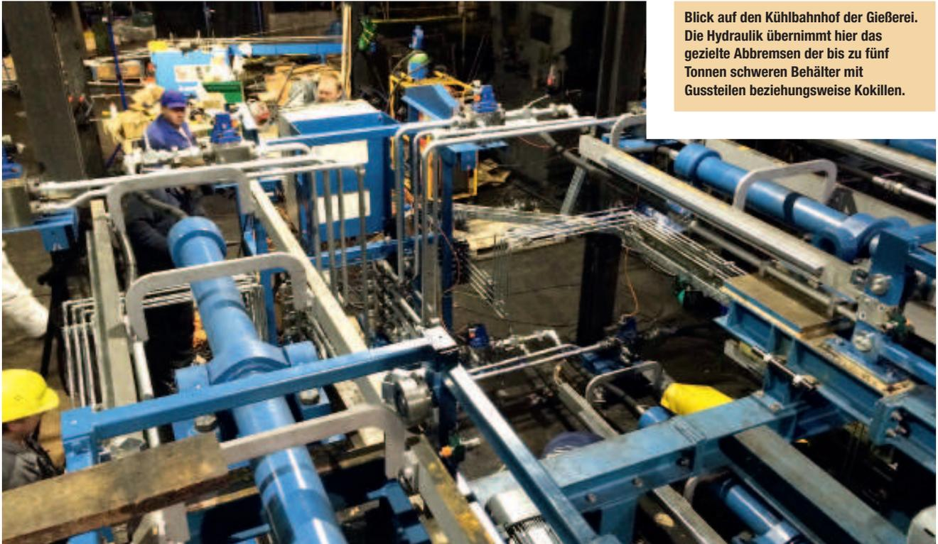
Blick auf den Kühlbahnhof der Gießerei. Die Hydraulik übernimmt hier das gezielte Abbremsen der bis zu fünf Tonnen schweren Behälter mit Gussteilen beziehungsweise Kokillen.
