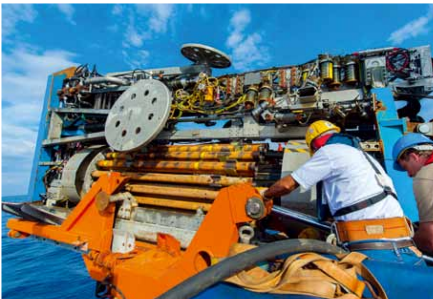
图中是带有液压部件和钻杆配件库的紧凑钻机结构。
